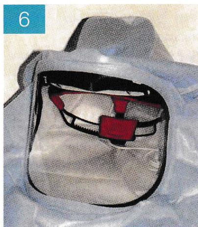
**Fig. 6** Esempio di casco dotato di visiera e cappuccio. La doppia ventola all'interno del casco permette l'ingresso di aria fresca filtrata e la fuoriuscita dell'aria respirata ricca di CO<sub>2</sub>
